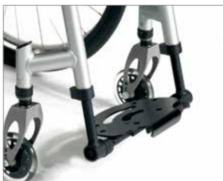
Un repose-pieds en aluminium, pliable et réglable pour le Quickie Neon CF.
